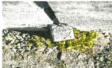
K5 既設プラスチック杭
